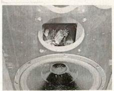
densità ed elevato calore specifico), che ha consentito di ottenere un Q quasi esattamente pari a 1. L'assorbente acustico, molto pressato, riempie totalmente anche il tubo di accordo del reflex, realizzato in cartone.
